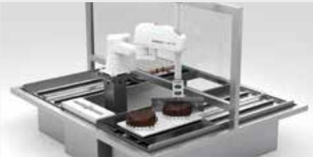
Merkmale wie die Schutzart IP65, korrosionsbeständige Bolzen und Faltenbalgabdeckungen machen die SR-12iA und SR-20iA Umweltoptionen ideal für sekundäre Lebensmittelanwendungen.
